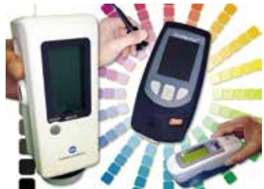
膜厚計・色差計・光沢計機器にて塗膜品質管理
