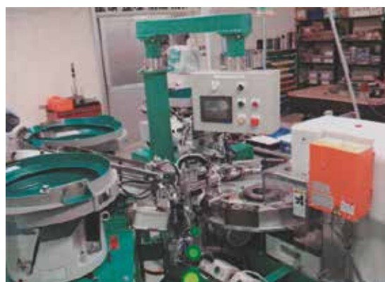
ネジ計量袋詰機
