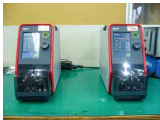
半自動剥離機
