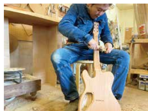
製作工程（ネック削り）
