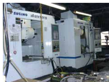
マシニングセンター (ATC-30) NC インデックス付き
