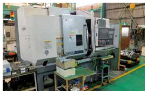
複合精密自動旋盤機械 OKUM-GENOS L300-M
