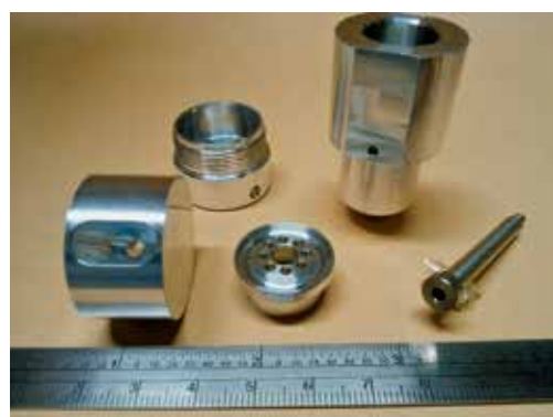
アルミ・ステンレスの加工部品例
