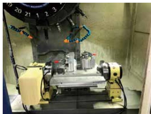
インデックスによる多面加工
