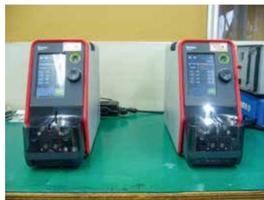
半自動剥離機
