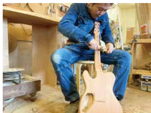
製作工程（ネック削り）
