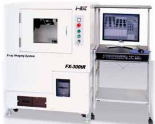
X線による非破壊検査
