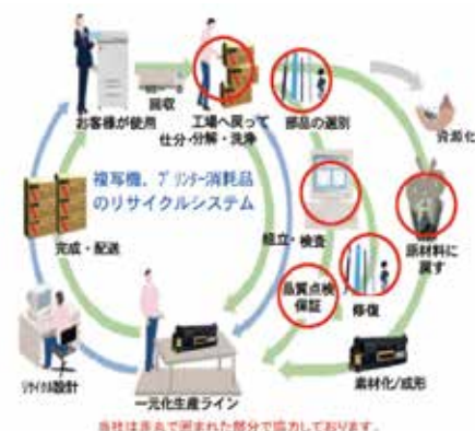
図 2 複写機・プリンター消耗品のリユース・リサイクルのサイクル
